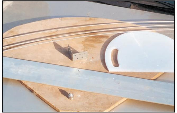
Plaque et tiges d'aluminium, planche à découper, socle S0 239, gabarit, quelques éléments nécessaires à la réalisation.
