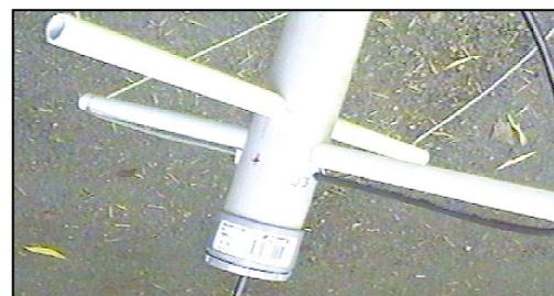
Figure 5 : Connexion à la partie inférieure de la grande boucle.
