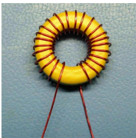
L1 = Tore T68-2 rouge = 24 spires fil de 5/10^{\text{ème}} de mm émaillé, valeur 3,3\mu\text{H}
