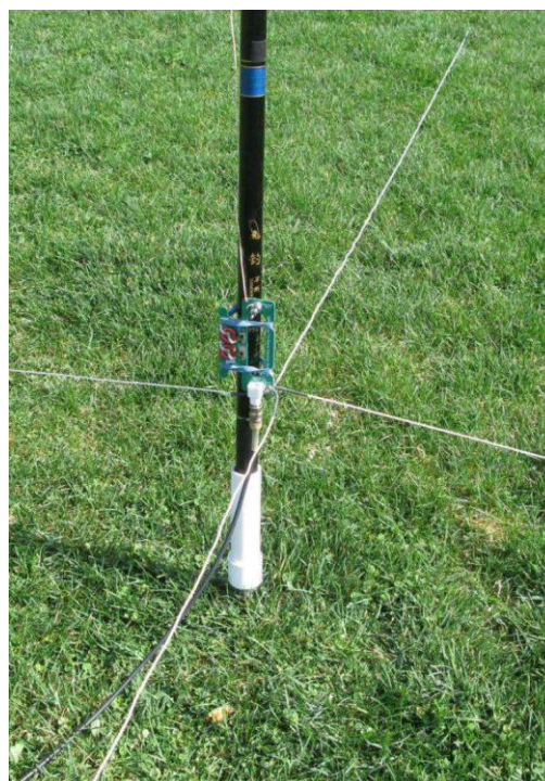
Autour du circuit imprimé se rattachent le brin vertical, les radians et la sortie BNC 50 Ohms.
