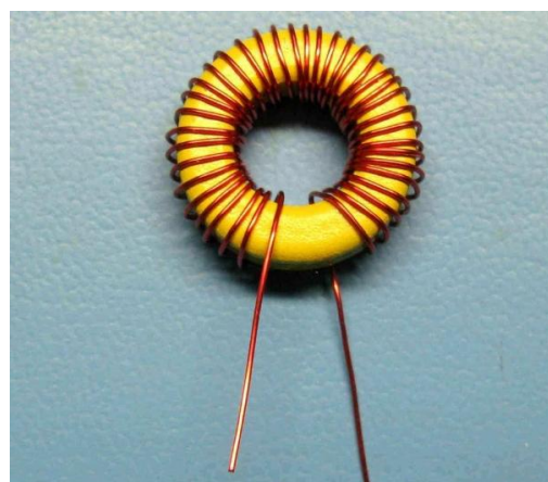
L2 = Tore T68-2 rouge = 38 spires de fil 5/10^{\text{ème}} de mm émaillé, valeur 8\mu\text{H} .
