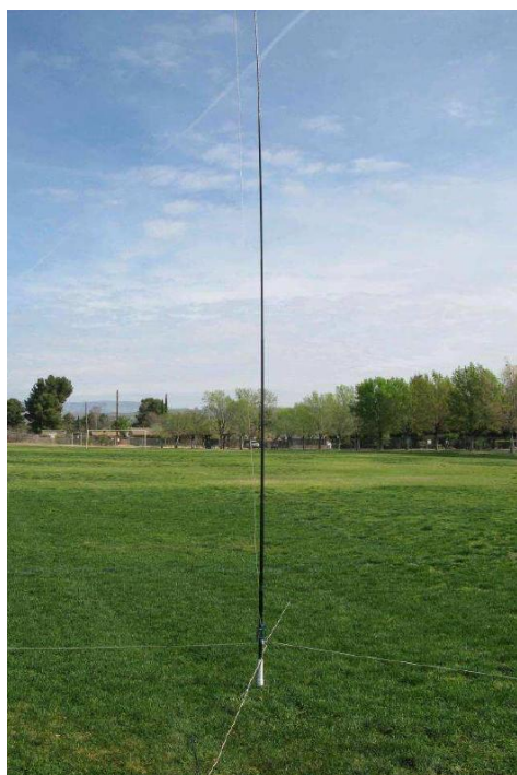
Antenne verticale et sa canne à pêche de 6 à 7 mètres de hauteur
