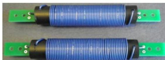
Insérez la carte de condensateur dans la bobine afin qu'elle soit centrée dans la forme, insérez aux extrémités de la bobine dénudée le fil dénudé dans le trou du PCB et soudez les fils aux PCB. Répétez ce processus avec l'autre bobine pour compléter le jeu de trappes pour le dipôle.
