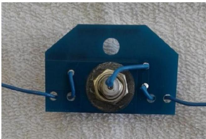
La connexion à la partie métal à mettre à la masse de la BNC se fait par contact avec le circuit imprimé et un fil permet la connexion entre la cosse centrale de la BNC et le fil de l'antenne qui passe dans différents trous pour le blocage. Une fois le fil soudé, ramener le surplus à travers les trous pour fixer le fil et empêcher tout mouvement des connexions soudées.
