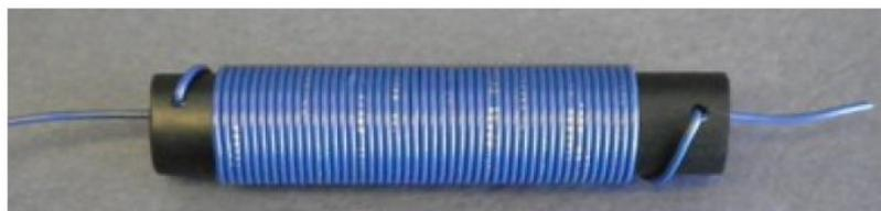
Enrouler les bobines en comptant un tour à chaque fois que le fil passe le point de départ. Gardez le fil aussi serré que possible et les spires bien jointes ensemble pendant l'enroulement.
