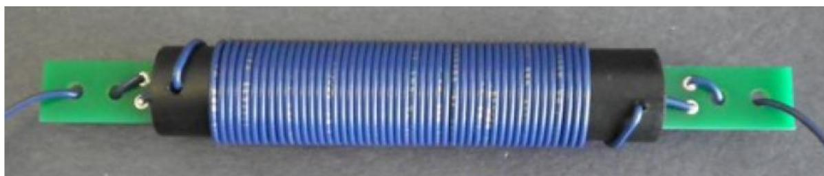
Glissez avec précaution une portion de gaine thermo rétractable sur chacune des bobines. Si certaines spires de la bobine sont déplacées ou séparées, utilisez un petit bâton plat ou un outil pour les remettre en place avant de rétrécir à la chaleur le tube.
